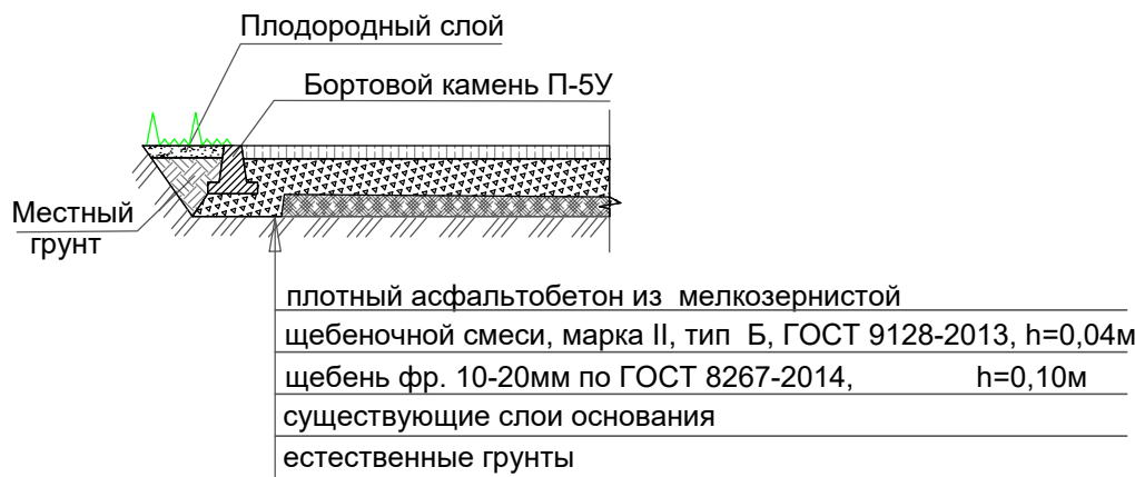
КОНСТРУКЦИЯ ПОКРЫТИЯ ТРОТУАРОВ И ОТМОСТОК Тип III
